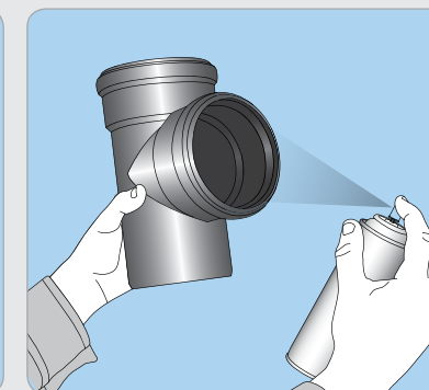
2. Limpieza y lubricación del O' Ring de doble labio M.O.L.
